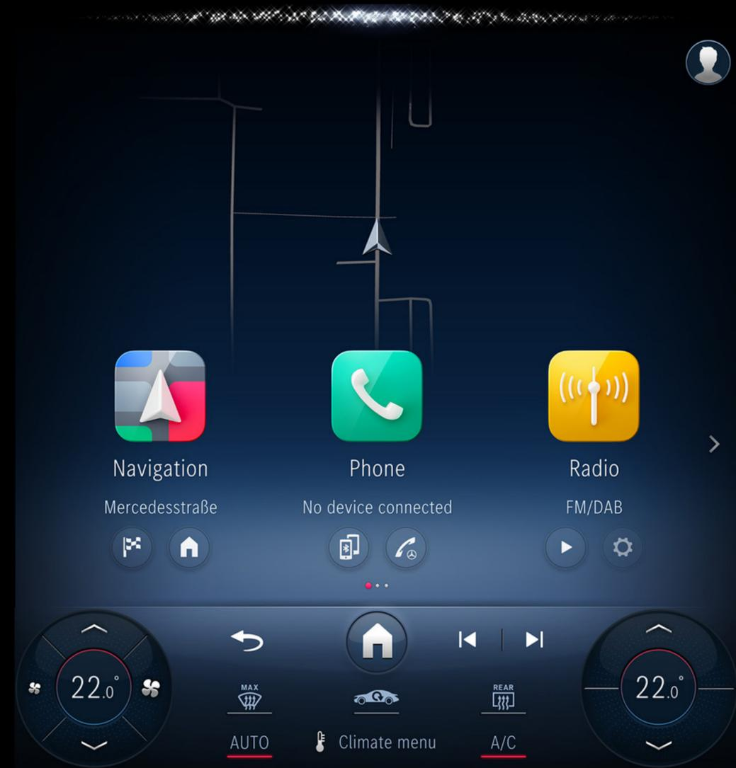
중앙에 위치한 11.9인치 고해상도 디스플레이를 통해 간단한 터치만으로 내비게이션 및 멀티미디어 시스템을 직관적인 제어가 가능합니다. 또한, 세로형 디스플레이는 운전자 쪽으로 약간 기울어져 있어 조작과 가독이 용이하며, 시야각과 빛의 조건에 구애받지 않고 주요 운전 정보와 같은 콘텐츠 확인이 가능합니다. (기본사양)
