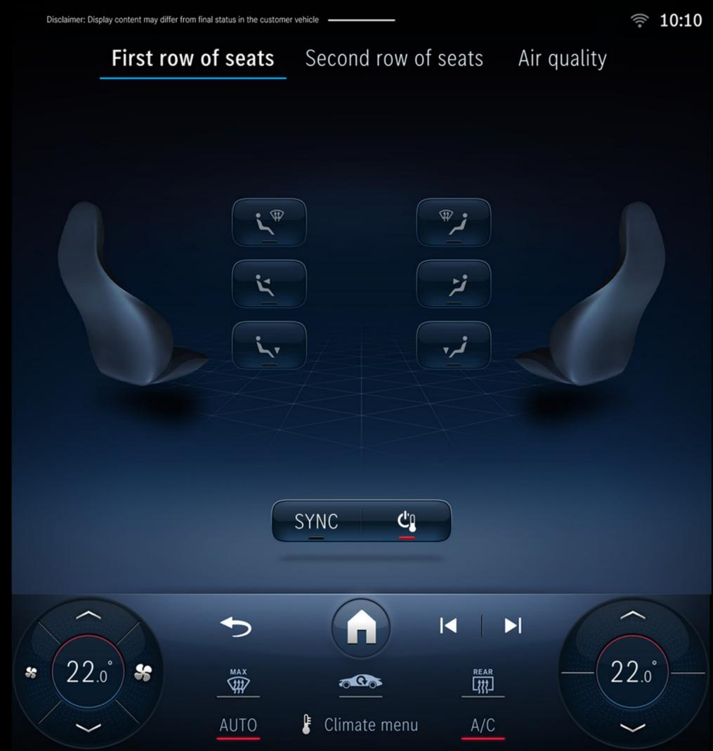
2개의 온도 조절 구역을 통해 운전석과 동승석의 온도를 개별적으로 관리할 수 있으며 섬세한 센서 시스템 덕분에 내부 온도를 수동으로 조정할 필요 없이 일정한 수준으로 유지합니다.
