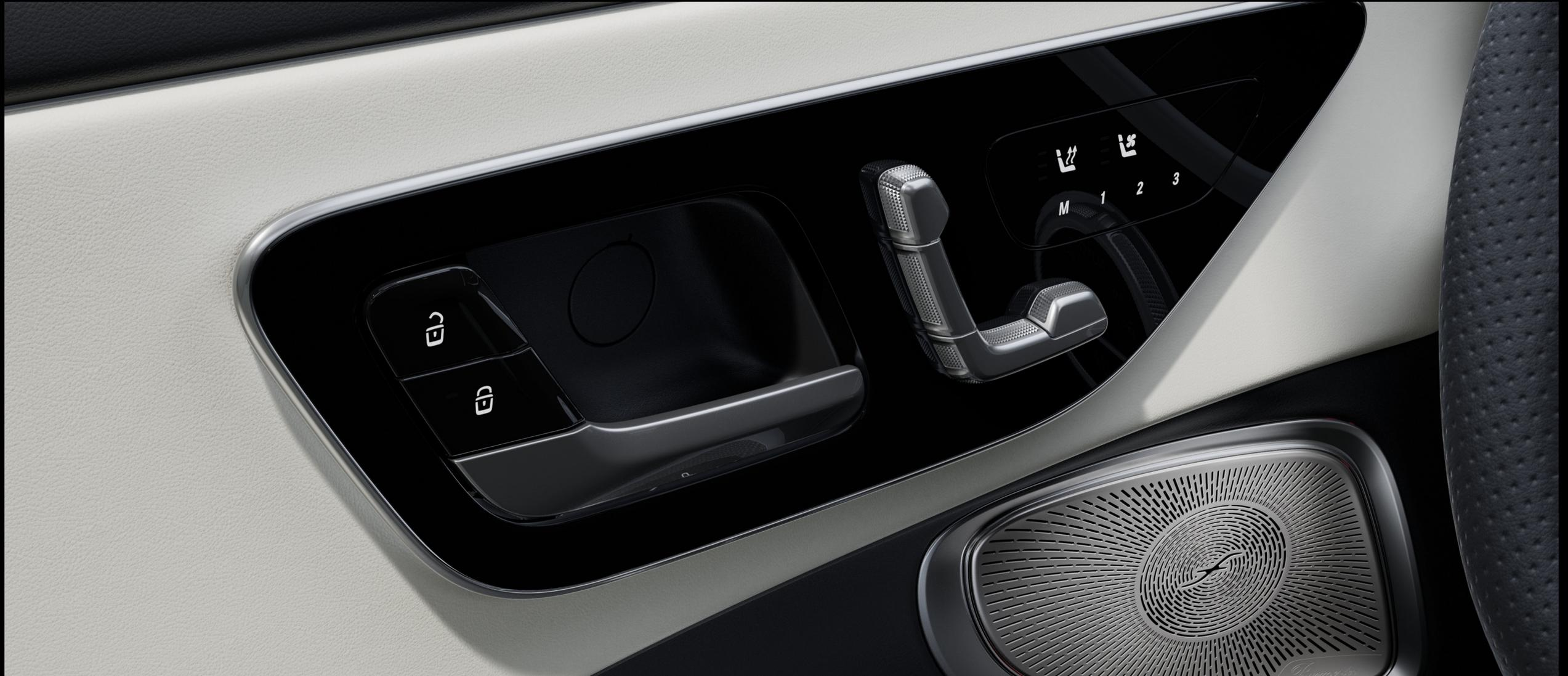
메모리 패키지는 최대 3개의 시트 위치를 편리하게 저장하고 불러올 수 있으며, 여러 운전자가 차량을 사용하고 시트 조정 시 운전자에 맞게 설정이 가능합니다. 또한, 8방향 조정 기능을 통해 앞 시트를 필요에 맞게 정밀 설정이 가능하여 장거리 주행 시 좌석의 편안함을 크게 향상시킵니다. 메모리 프로그래밍에는 시트 높이 및 전후방 위치, 시트 쿠션 각도, 시트 등받이 각도 및 헤드레스트 높이와 같은 모든 시트 조정 설정이 포함됩니다. (기본사양)
